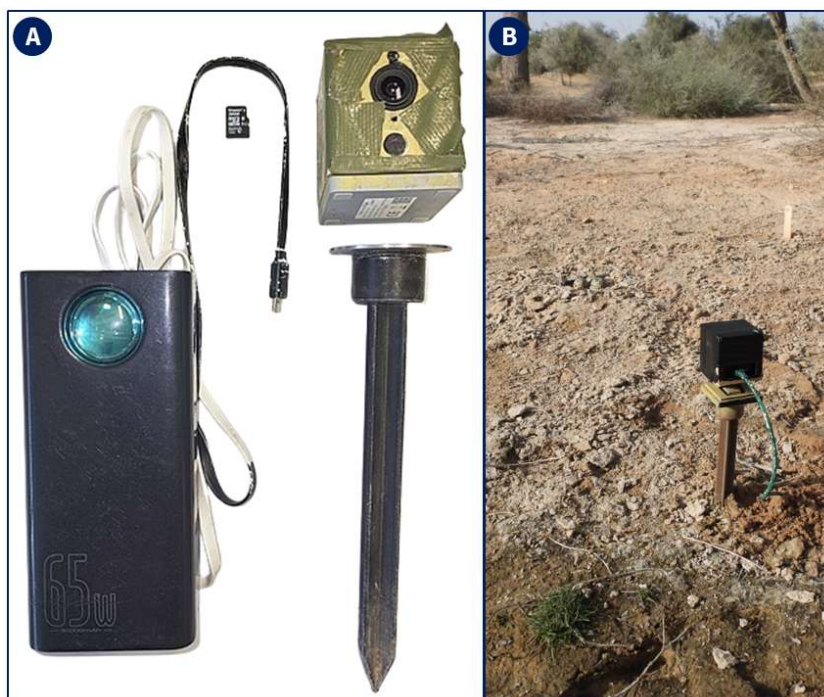
Obrázek 7: A) kompletní set pro snímání chování na hnízdě: powerbanka, napájecí kabel, microSD karta, kamera a stojánek, B) instalace kamery u hnízda.
