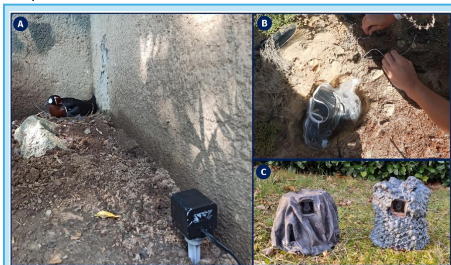
Obrázek 11: A) Umístění kamery ve voliérě, B) ukrytí powerbanky do substrátu, C) skrytí na kameru imitující kámen.
