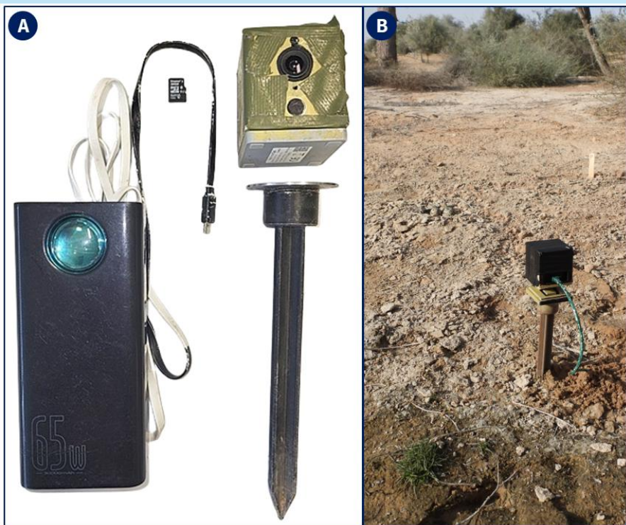
Obrázek 12: A) kompletní set pro snímání chování na hnízdě: powerbanka, napájecí kabel, microSD karta, kamera a stojánek; B) instalace kamery u hnízda.
